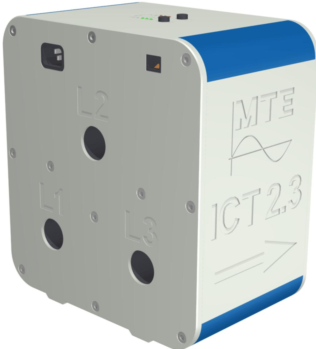
Der dreiphasige Stromtrennwandler ICT 2.3 wird auf Mehrplatz-Prüfeinrichtungen eingesetzt, wenn Dreiphasenzähler mit geschlossenen Verbindungen zwischen Strom- und Spannungsmesskreis (Eichverbindungen) geprüft werden müssen. Es werden immer mehr Zähler dieses Typs produziert und eingesetzt.
